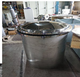
炭基發酵槽主槽與蓋子
